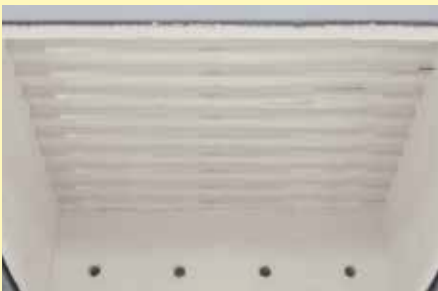
Kuvars cam borular içinde korunmuş olan ve yan yana bitişik konumda düzenlenmiş tavan rezistansları
