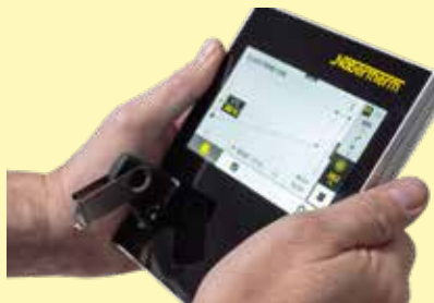
Bağlı kontrol ünitesinden USB belleği aracılığıyla işlem verilerinin kaydedilmesi
