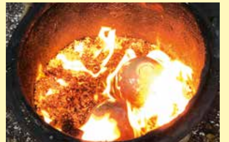
Ürünlerin soğutulması ve yaprak, saman veya talaş içine daldırılması
