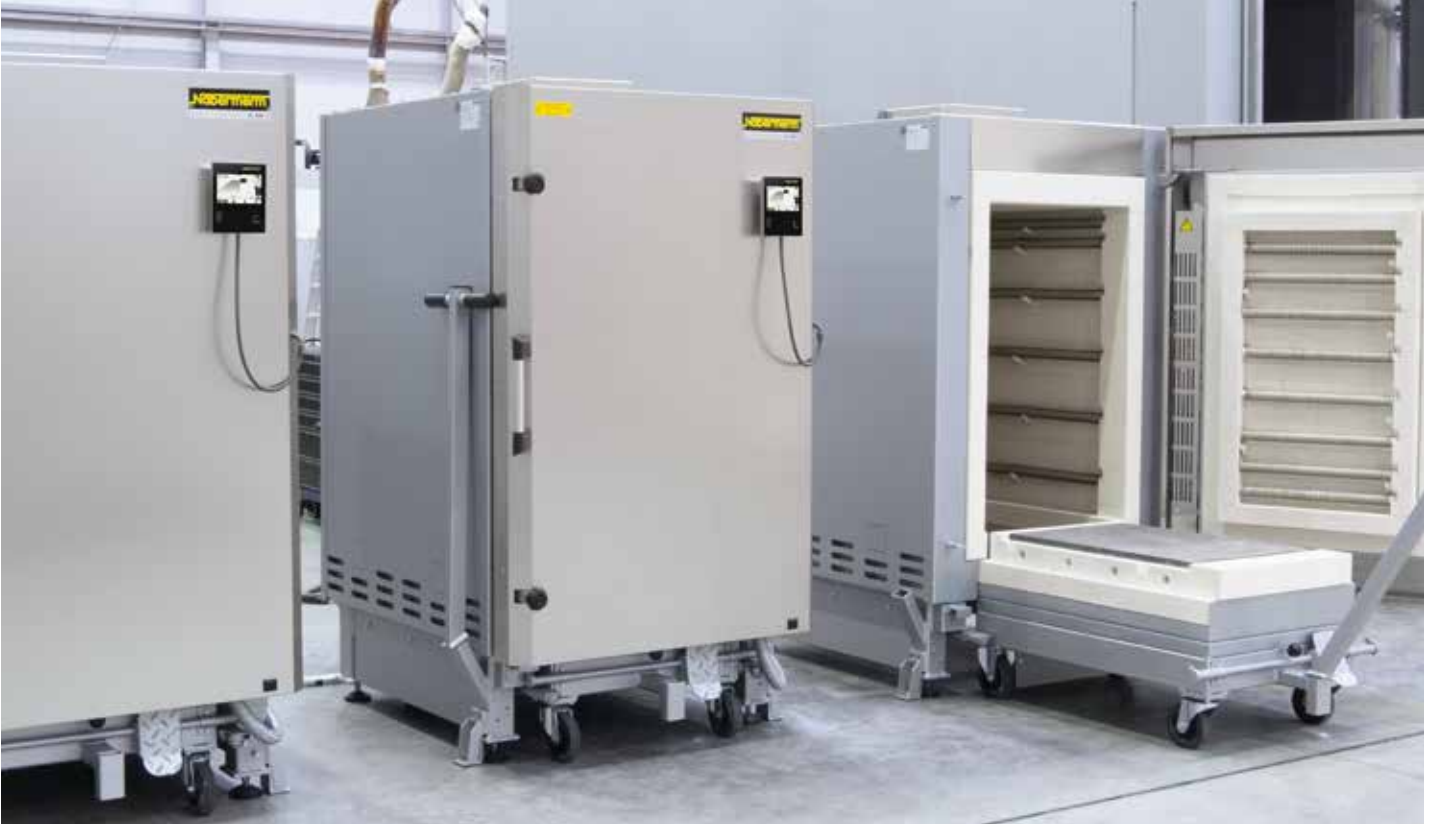
Piştirme odasının ergonomik olarak yüklenmesi için dışarı çekilebilir arabalı hazneli fırınları
