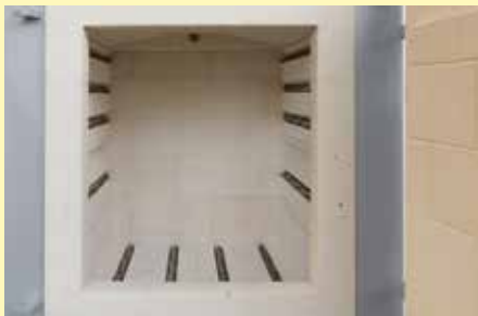
Oluklar içinde korunmuş şekilde düzenlenmiş rezistanslar ile üç taraftan ısıtmalı
