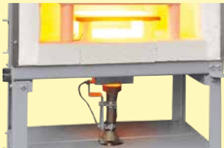
Fırın altına monte edilmiş 15 kW propan gaz brülörü
