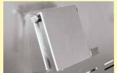
Havalandırma, soğutmayı hızlandırma ve partinin gözlenmesini sağlayan kilitli delik
