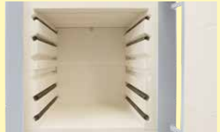
Oluklar içinde korunmuş şekilde düzenlenmiş rezistanslar ile iki taraftan ısıtmalı
