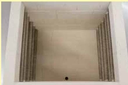
Taşıyıcı borular üzerinde bulunan rezistanslar serbest bir ısı ışınlamasını sağlar
