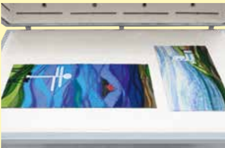
Tek bir Fusing fırınından cam fusing iş parçaları (Jo Downs Glass Design Ltd.)
