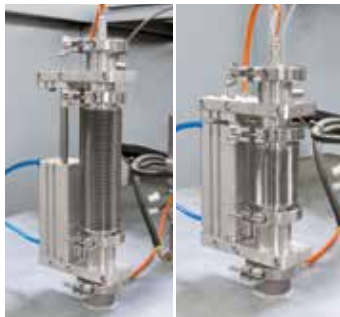
Termocoppia di tipo S con dispositivo di estrazione automatica per ottimi risultati di regolazione nel campo di temperatura inferiore
