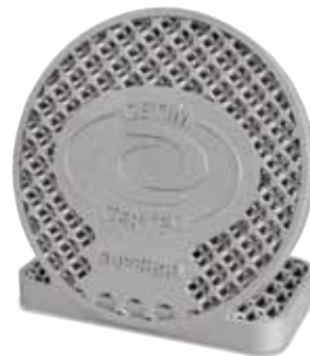
Componente stampato in alluminio, sottoposto a trattamento termico nel modello N 250/85 HA (fabbricante CETIM CERTEC su piattaforma SUPCHAD)
