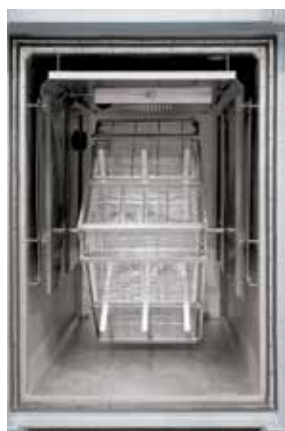
Telaio rotante a motore con cestelli integrati per la movimentazione della carica durante il trattamento termico
