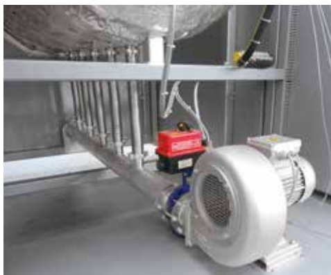
Raffreddamento a ventola forno a storte a pareti calde NRA 400/03
